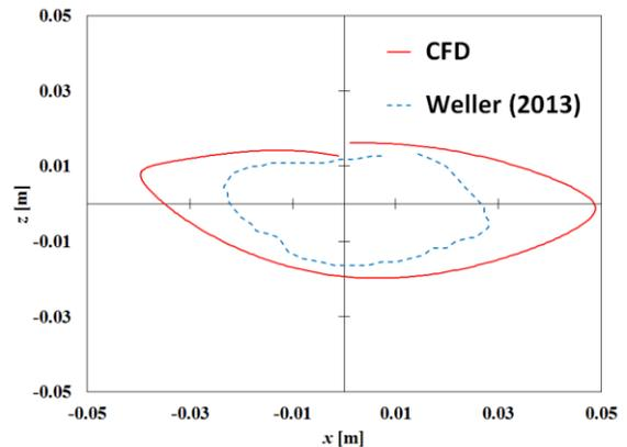
FIGURE 5: MOTION OF BOBBER UNDER INFLUENCE OF A REGULAR WAVE TRAIN.
