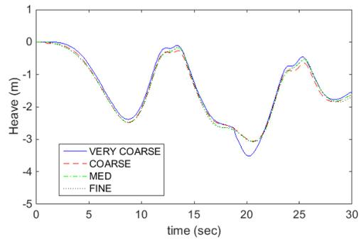
FIGURE 8: MODEL WEC PTO HEAVE MOTION (CONVERGENCE) PLOT.
