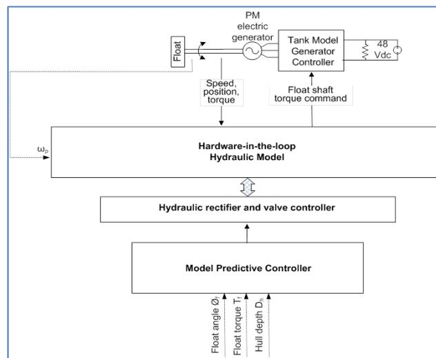
FIGURE 1. WAVE TANK VALIDATION BLOCK DIAGRAM.
