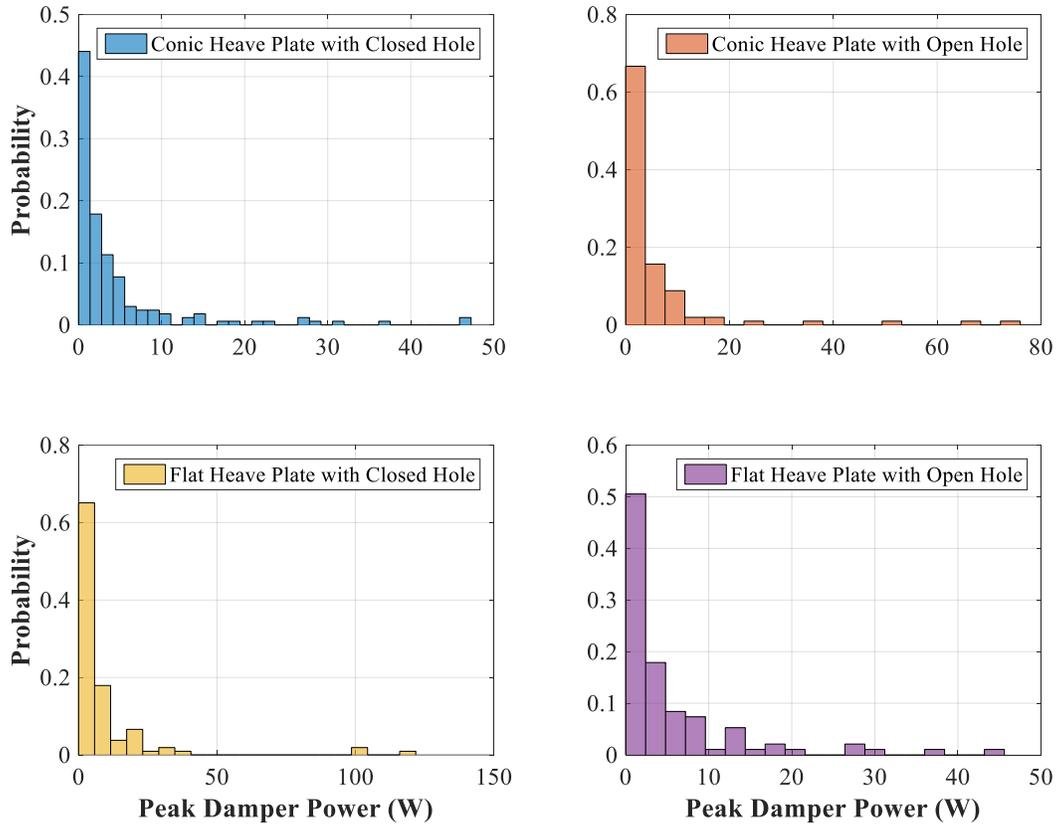
**FIGURE 1. PEAK DAMPER POWER DISSIPATION FOR FOUR HEAVE PLATE CONFIGURATIONS.**
