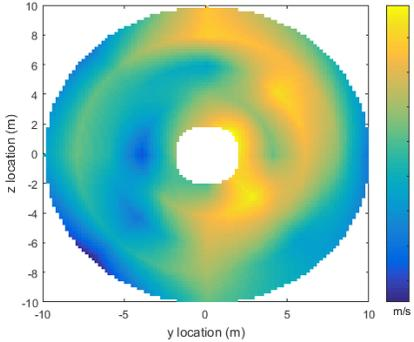
**FIGURE 3. VELOCITY IN THE STREAMWISE DIRECTION FOR AN INSTANTENOUS TIME.**
