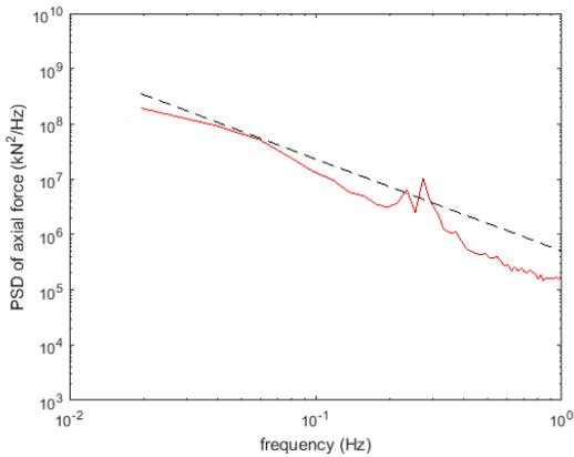
**FIGURE 7. AXIAL FORCE SPECTRA ON ONE OF THE BLADES FOR TI=5%.**
