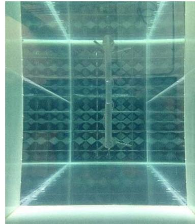
**FIGURE 1. ACTIVE GRID TURBULENCE GENERATOR AT LEHIGH (VIEW FROM ACRYLIC WINDOW IN EXIT PLENUM)**
