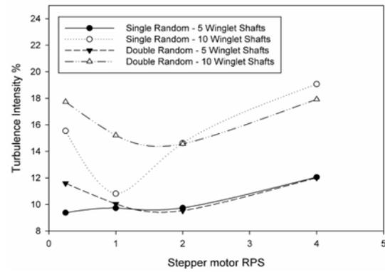
FIGURE 3. TURBULENCE INTENSITIES OBTAINED WITH THE GRID
