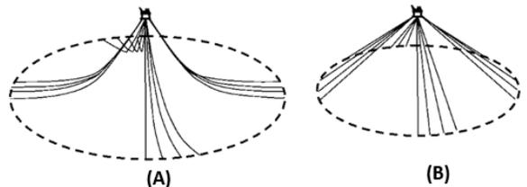
**FIGURE 5.** (A) CATENARY MOORING AND (B) TAUT LEG MOORING CONFIGURATION [5].
