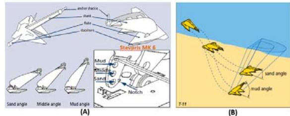
**FIGURE 4.** (A) DEA CONFIGURATION [12]; (B) INSTALLATION PROCEDURE OF DEA [12].
