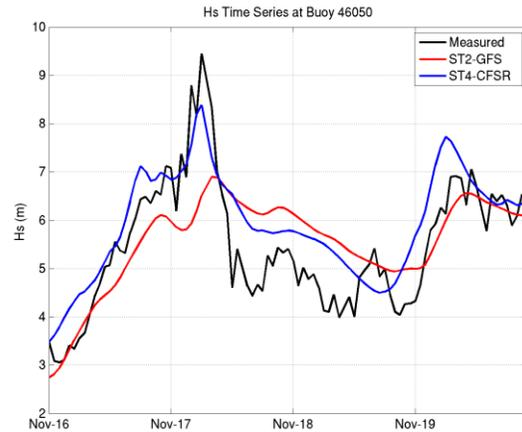
**FIGURE 3 SIGNIFICANT WAVE HEIGHT TIME SERIES FOR SIMULATED EVENT**
